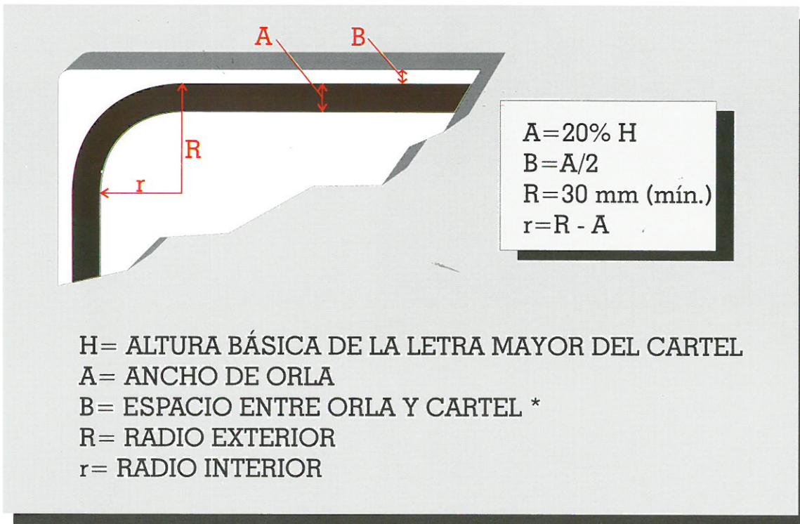
(\*) Las cotas indicadas de A y B son las ideales, pero se podrán adaptar en función del sistema de fabricación del cajón, siendo por tanto variables.
