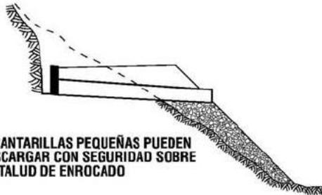
ALCANTARILLAS PEQUEÑAS PUEDEN DESCARGAR CON SEGURIDAD SOBRE UN TALUD DE ENROCADO
