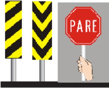
*Los dispositivos de canalización tienen por objetivo guiar y advertir al usuario en la conducción, respecto de los bordes de la plataforma de un camino durante la noche o en condiciones de escasa visibilidad, o mostrar dos direcciones divergentes posibles de circulación en una vía unidireccional, o mostrar la dirección de una curva, cuya geometría imponga una restricción en la velocidad de circulación. Se codifican con las letras DC.*
