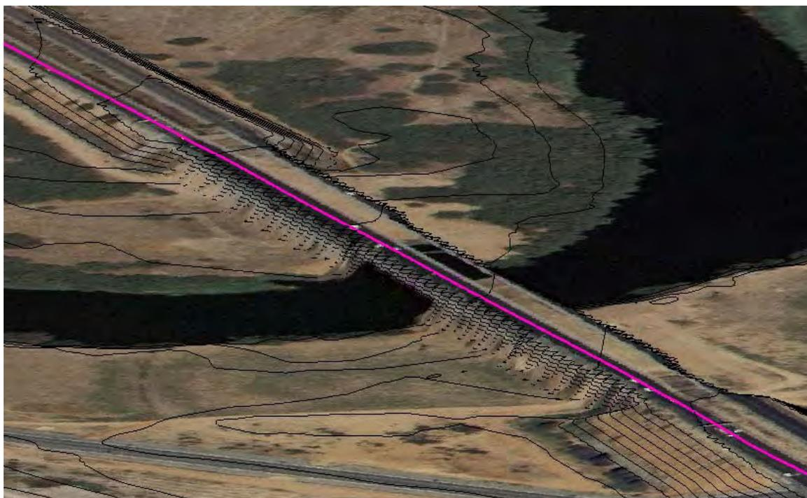
*Elevación del MDT para obtener una plataforma continua que simule el tablero del viaducto*
