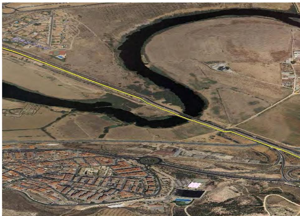
*Visualización del eje de la carretera en 3D apoyado en el MDT del PNOA*
