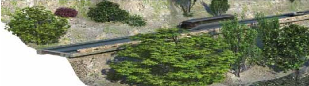
**Fig. 1. Solución de ampliación de la plataforma en voladizo para reducir los impactos**
