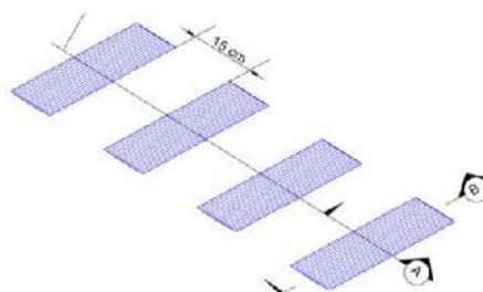
*Ilustración 3: Vista isométrica de GSLF de tipo paralelogramo.*
