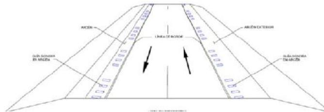
Ilustración 7: Ejemplo de patrón discontinuo de GSLF.
