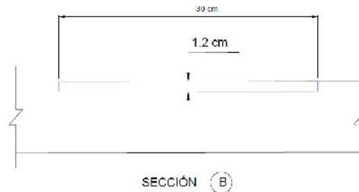
Ilustración 4: Sección transversal de GSLF de tipo paralelogramo.
