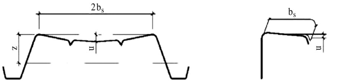
Figura 73.7. Combadura de alas (u)
