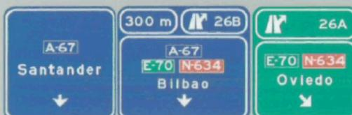
Señales sobre la calzada en autopista o autovía. Dos salidas inmediatas muy próximas hacia vía rápida y dirección propia
