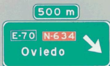
Preseñalización con señales sobre la calzada en carretera convencional hacia vía rápida
