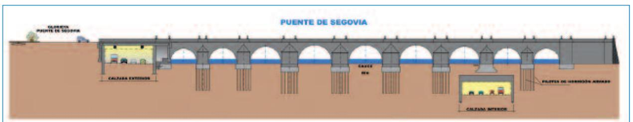
Sección del trazado de los túneles a su paso por el Puente de Segovia.
